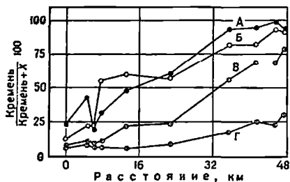
Рис. 6-8. Воздействие переноса на composition гальки в Ринд-Крик, Блэк-Хилс, штат Южная Дакота. По [163].
