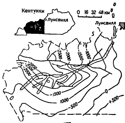
Рис. 5-3. Русло Бетель (миссисипий) и структурная карта по кровле глин Нью-Олбани, западная часть Кентукки
