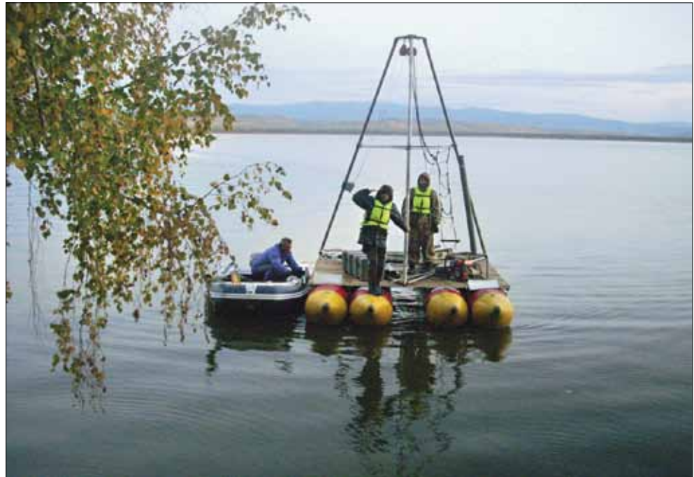
Буровая установка готова к бурению скважины на озере Котокель, где был получен керн длиной 14 м.
