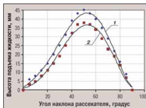
Зависимость высоты подъема жидкости от угла наклона рассекателя при одинаковых (1) и различных (2) плотностях
