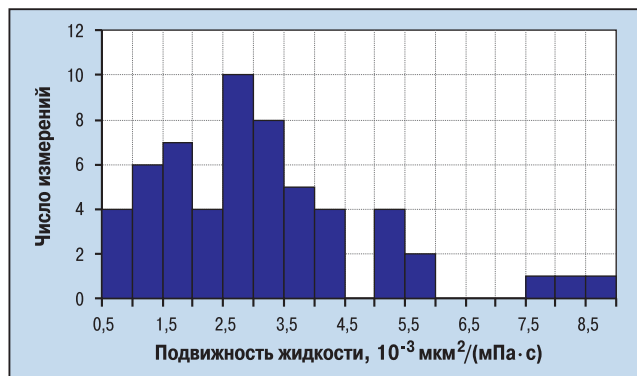
Рис. 1. Распределение эффективной подвижности жидкости вблизи нагнетательных скважин по данным интерпретации КПД
